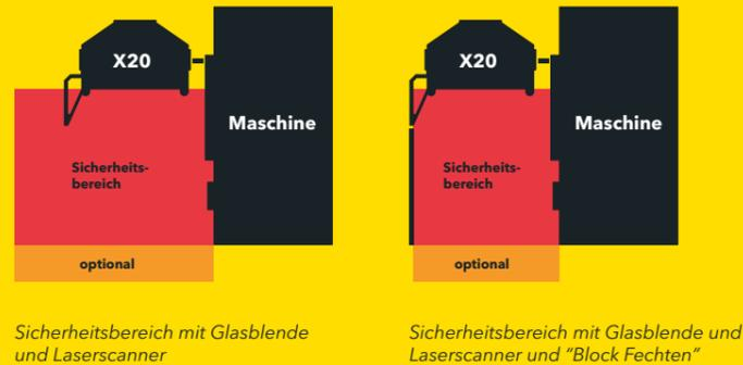
Lichtvorhang · Unsichtbare Abschirmung (Produktionsunterbrechung)
